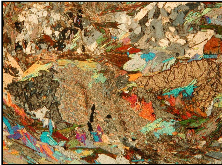
Abbildung 7: Porphyroblastisches Grundgefüge mit stark frakturiertem Granat, teilweise in Biotit umgewandelt, Staurolith, Kyanit, Biotit. Dünnschliff PG 15, gekreuzte Nicols, Bildbreite 8 mm
