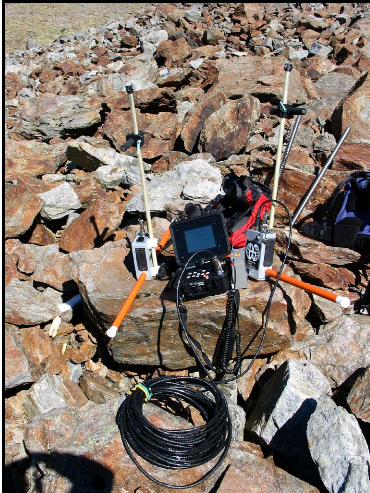
Abbildung 28: Georadarsystem, bestehend aus Sende- und Empfangseinheit incl. längenverstellbarer Antennen (orange), Batterien, Verbindungskabel und Laptop
